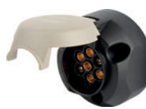
Steckdose Pol-Anzahl 7 6 – 12 V DIN/ISO 3732 S-Typ Kunststoff
